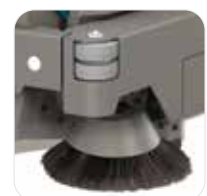
Tweezijdige zijveegborstels verzekeren dat het hele schrobpad wordt geveegd
